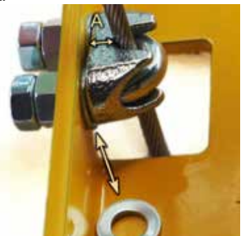
Kuvan autossa poljin liikkuu vaakasuorassa, jolloin vaijerin kiinnike polkimessa ja haarukkaliitin rintapellissä ovat samalla tasolla.
